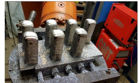
Vorherige Fertigung von Aluminiumbauteilen mittels WAAM
