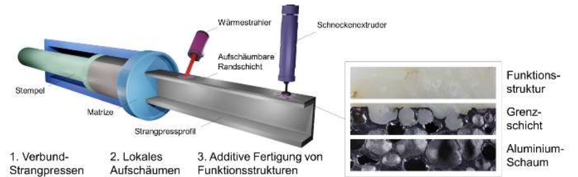
Schematische Darstellung der Prozesskette im HyFunk-Projekt; Projektpartner und ©: IWF (TU Braunschweig)
