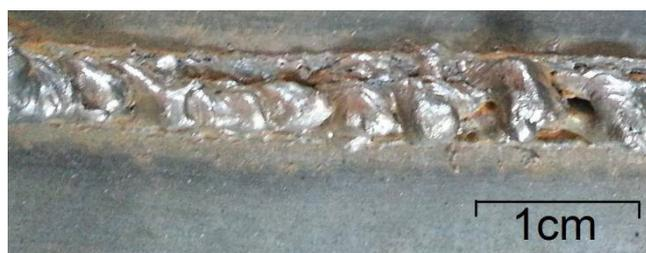
**Abbildung 3-17: Düsen-Werkstückabstand 20 mm, Schweißspannung 28 V, Schweißstrom 160 A**
