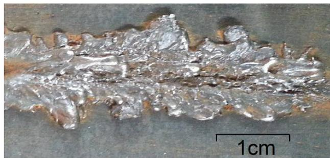
**Abbildung 3-16: Düsen-Werkstückabstand 10 mm, Schweißspannung 28 V, Schweißstrom 160 A**
