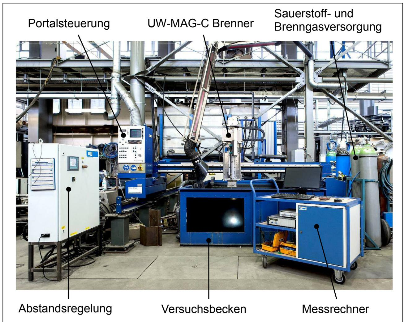
**Abbildung 3-9: Versuchsstand für geringe Wassertiefen**
