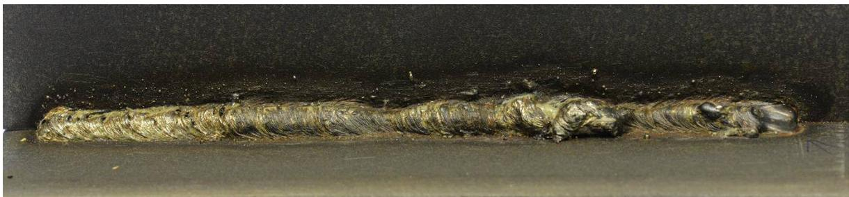
**Abbildung 3-35: Manuelle UW-MIG Schweißnaht, Wassertiefe: 3m**
