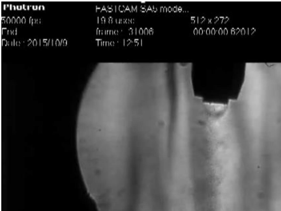
**Abbildung 3-13: Schlierenoptische Aufnahme der Gasströmung**
