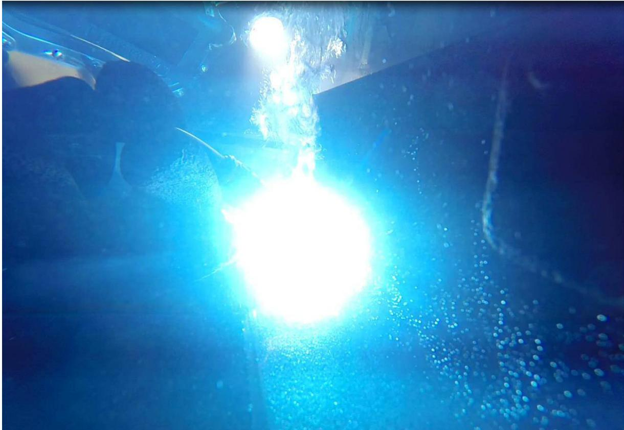
**Abbildung 3-34: Prozessevaluierung: Laufender UW-MIG Prozess, Schweißposition: PB**
