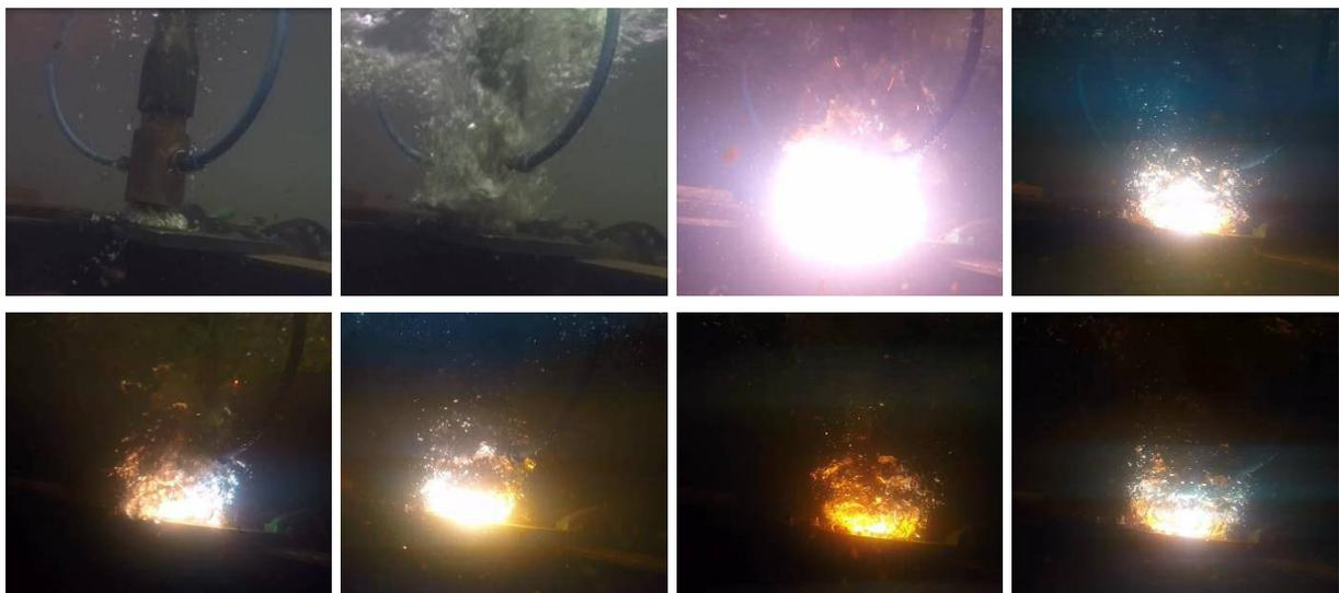
**Abbildung 3-15: Einsatz des außenmischenden Düsensystems mit Wasservorhang beim Unterwasserschweißen**
