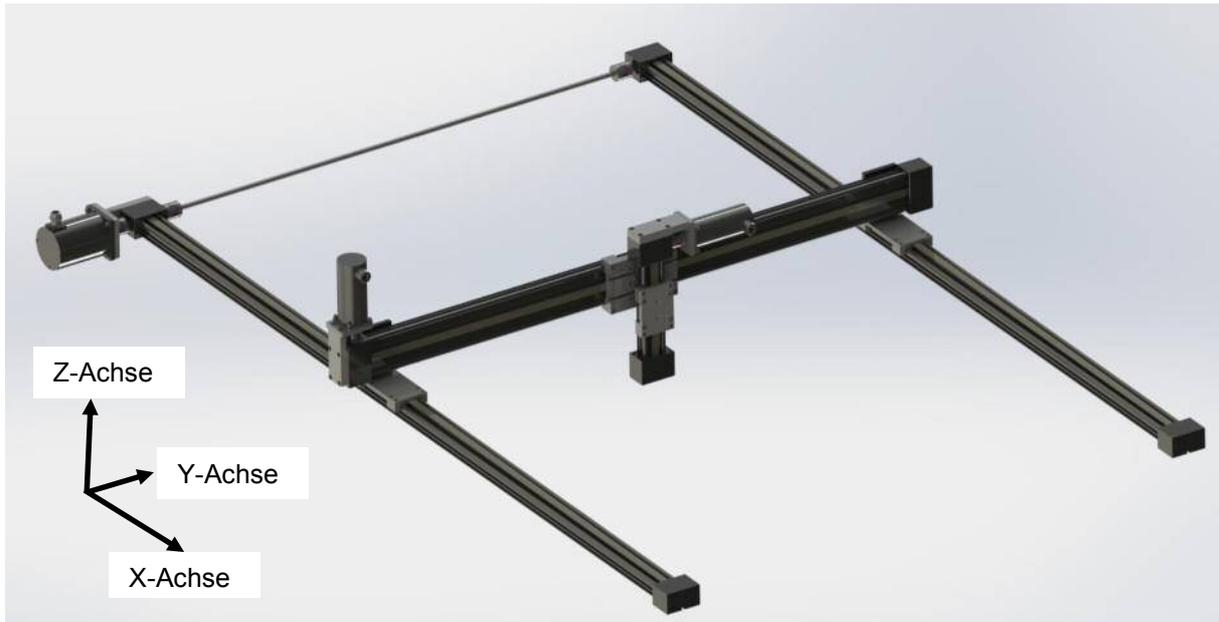
**Abbildung 3-3: drylin E Raumportal ohne Zusatzanbauten und Montagehilfen**
