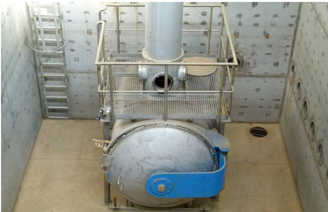
Abbildung 3-1: Innenüberdruckkammer mit angeflanschem Steigrohr
